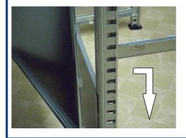
2. Alle weiteren Elemente einhängen und in den Pfeilerschlitzen gut nach unten drücken.
