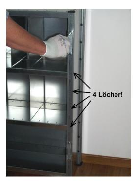
3. Unteres Tablar anheben und Profil mit Verschlusslasche aufstecken. Die Verschlusslasche muss sich leicht rechts von der Mitte befinden.
