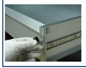
3. Grosse Messingmutter von hinten aufschrauben und Schlosszylinder fixieren.
