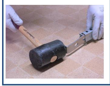
2. Lenkrolle aufstecken und mit Innensechskantschraube sichern. Am besten Innensechskant mit Kugelkopf verwenden oder zum Anziehen kurz das Rad entfernen.
