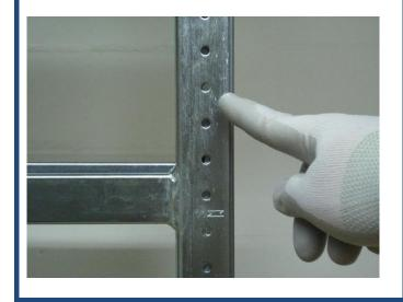
2. Längsstabilisierung mit total 4 Blechschrauben sichern. Die Schrauben bieten beim Eindrehen etwas Widerstand, da sie sich ihr Gewinde selbst schneiden.
