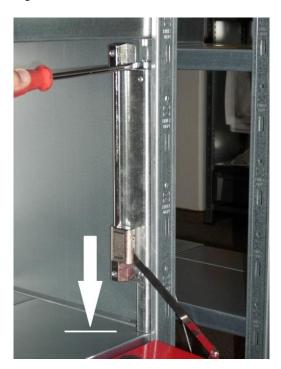
5. Öffnungsgeschwindigkeit mittels Justierschrauben einstellen (Richtung Uhrzeigersinn=schneller, Richtung Gegenuhrzeigersinn=langsamer).
