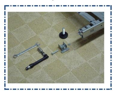
1. Halterung auf unteres Pfeilerende stecken, mit Schraube und Mutter sichern.
