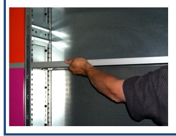
7. Türen zuerst in die obere Nut schieben, dann ausrichten und in die untere Nut stellen. Die hintere Türe zuerst einhängen.
