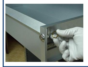
4. Riegel wie folgt mit Schraube (oder mit kleiner Mutter, je nach Ausführung) befestigen: Schlüssel im Uhrzeigersinn bis zum Anschlag drehen (Schloss verriegelt). Riegel in waagrechter Position befestigen.
