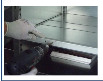
3. Bohrlehre entfernen. Scharniere einstecken. Muttern mit Steckschlüssel 8 mm anziehen.
