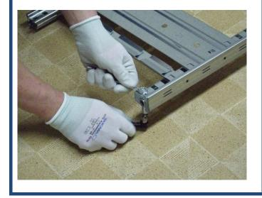
2. Fuss provisorisch einschrauben. Am fertig montierten Regal die Füsse definitiv mit Hilfe der Wasserwaage ausrichten.
