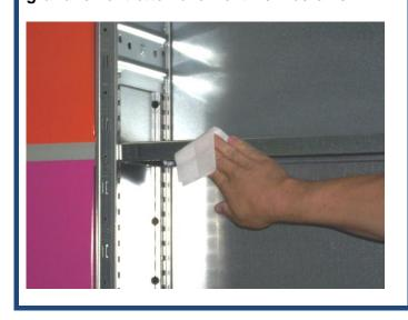
4. Schiene am Tablar ausrichten und an beiden Enden aufs Tablar drücken.
